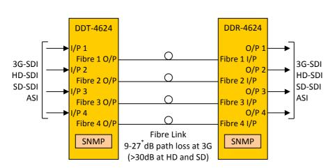
BLOCK DIAGRAM DDT-4624 & DDR-4624 SIGNAL PATH
